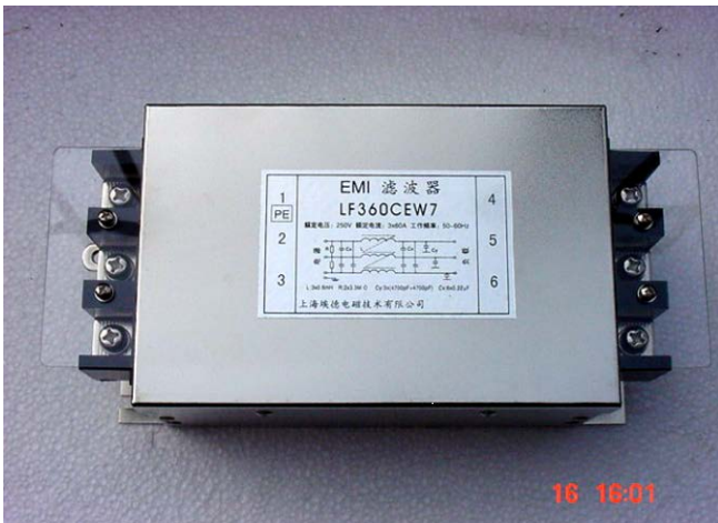
图 13 为某变频调速电梯配套的 EMI 滤波器
